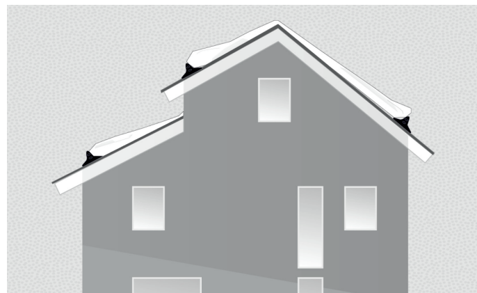
Снегозадержатели устанавливают на каждый скат многоуровневых крыш
